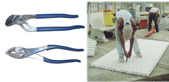
Figura No.37: Tenazas. Instrumento para colocar alambre de amarre en uniones de paneles EMMEDUE.
