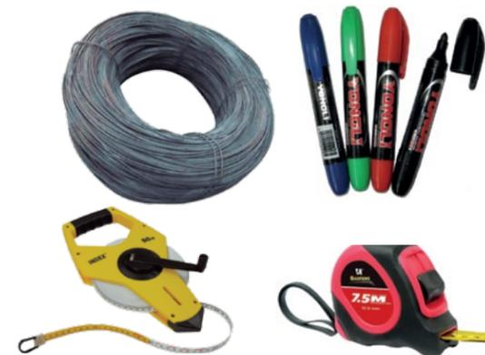
Figura No.38: Herramientas auxiliares en el replanteo de las obras con paneles EMMEDUE.
