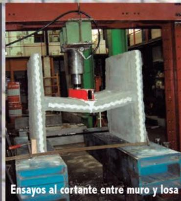
Ensayos al cortante entre muro y losa
