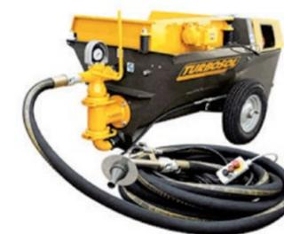
Figura No.27: Instrumento para proyección de mezclas de concreto o mortero
