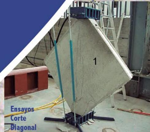
Ensayos Corte Diagonal
