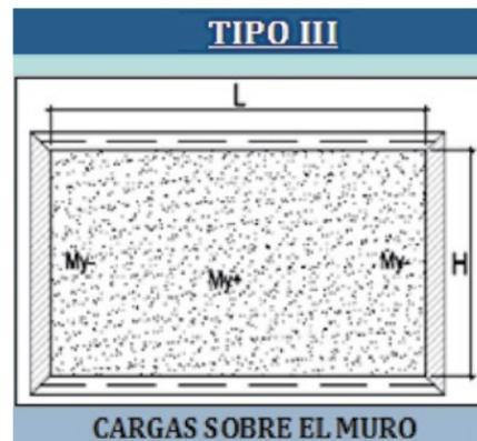
Fuerza Sísmica sobre el muro
